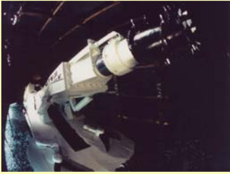
きかいの先についたドラムで石炭をほる「ロードヘッド」
