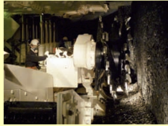
左右2このドラムでかべを一度にけずる「ドラムカッター」
