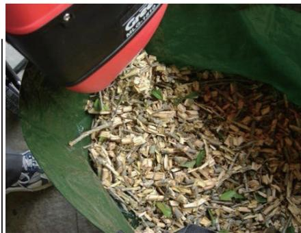
▲ 電動式の剪定枝チップ機でチップ化された枝。比較的細かく破碎される。
