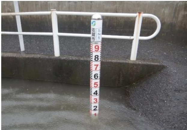
浸水標尺の設置
