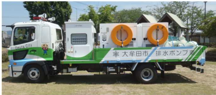
図 4.3.6 排水ポンプ車の導入
