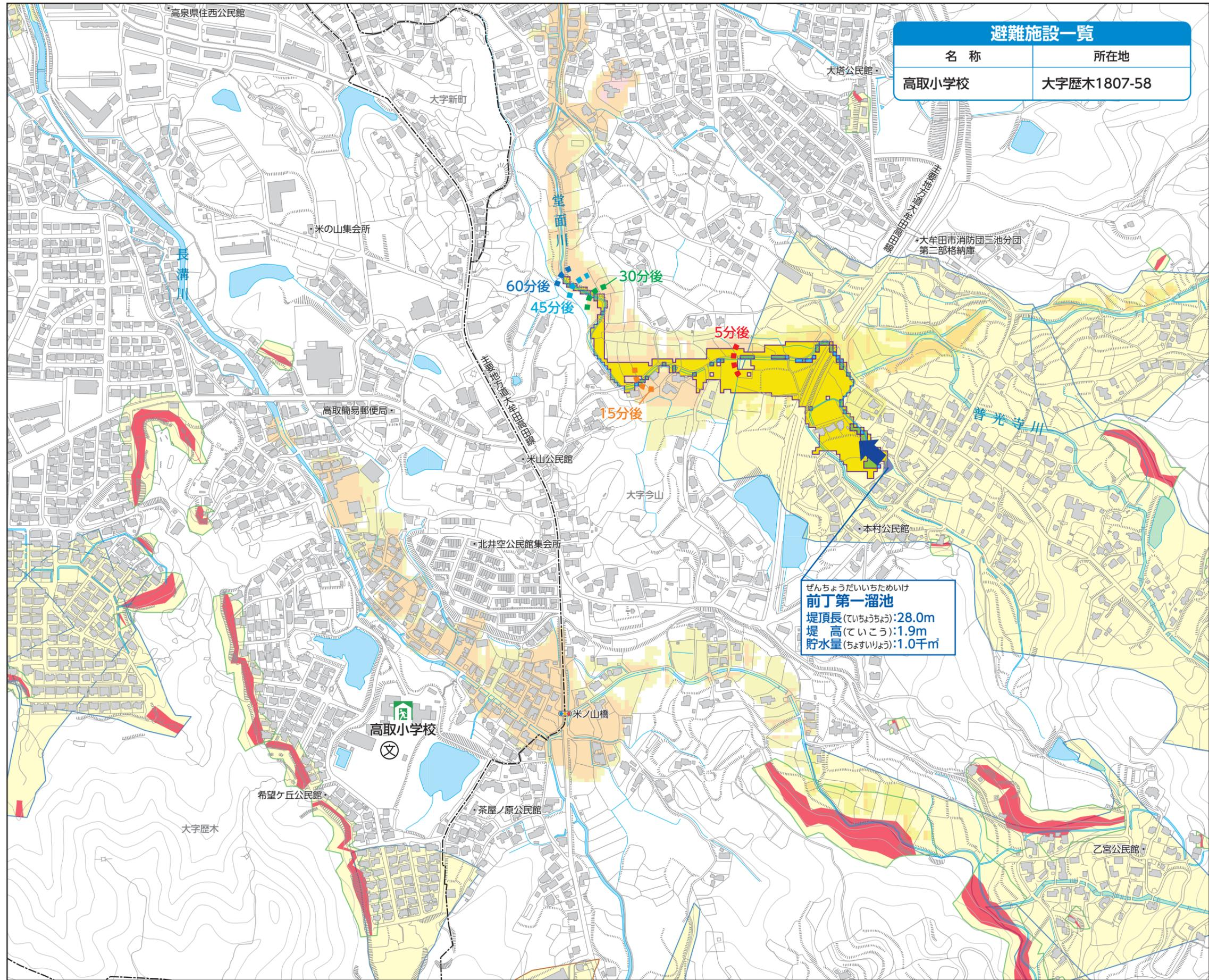
このハザードマップは、地震等によって、ため池の堤体が決壊した場合に、どのような浸水被害となるかを知るために、ため池の水が満水位の状態<sup>けっかい</sup>で決壊し、全ての貯水量が瞬時に流出する状況<sup>けっかい</sup>(決壊後60分)を想定して作成されたハザードマップです。ため池決壊時には、同時に他の災害が発生する可能性もありますので、常日頃から危険箇所を把握し、安全な避難を心がけて下さい。
