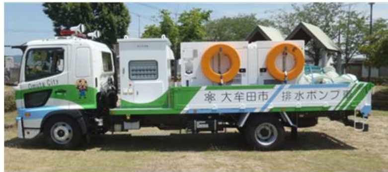
図 4.3.6 排水ポンプ車の導入
