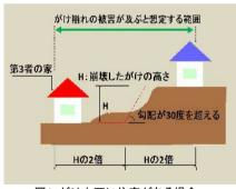
がけ崩れの被害が及ぶと想定する範囲 H:崩壊したがけの高さ 公共施設 勾配が30度を超える Hの2倍 Hの2倍
