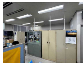
収納庫が適切に固定されていない所が多い。
