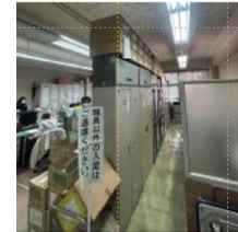
固定されていない収納庫の上に段ボール等が積み重なっている。
