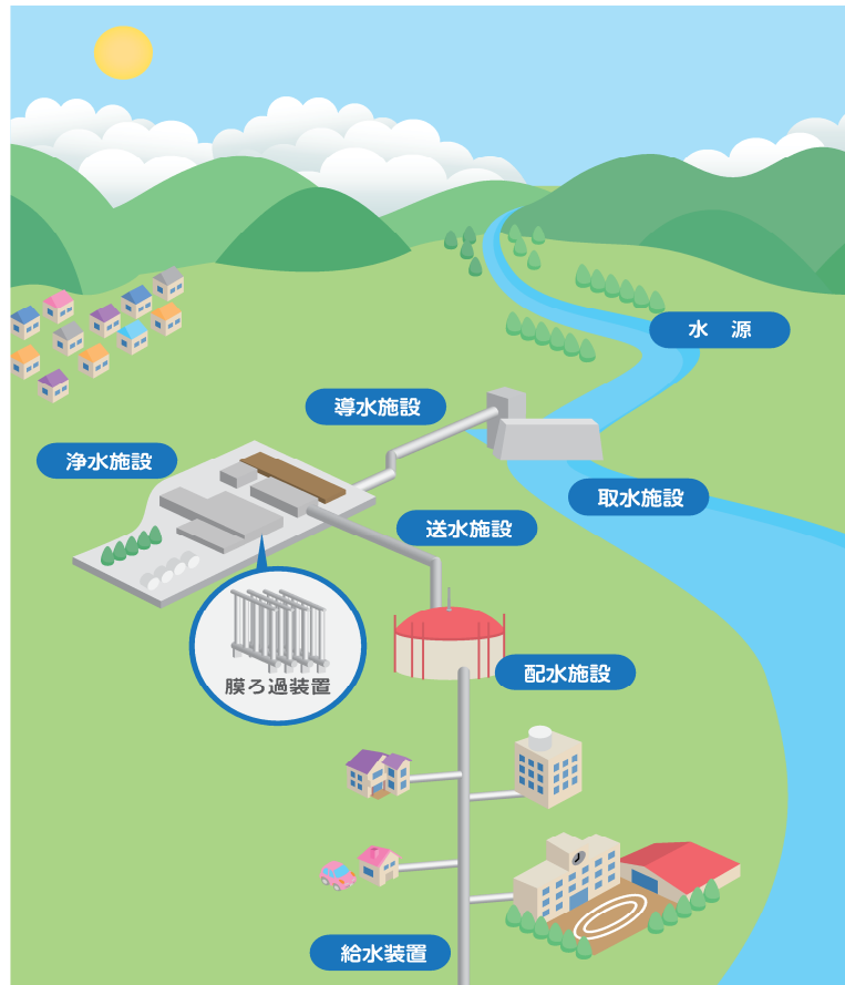
図 2-1 水道水ができるまでの全体工程図
