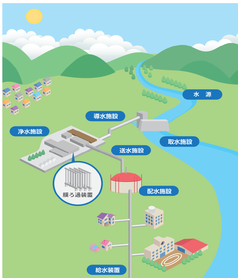
図 2-1 水道水ができるまでの全体工程図
