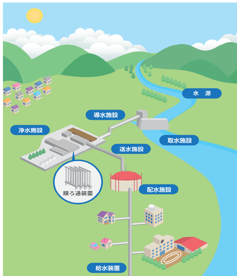
図 2-1 水道水ができるまでの全体工程図
