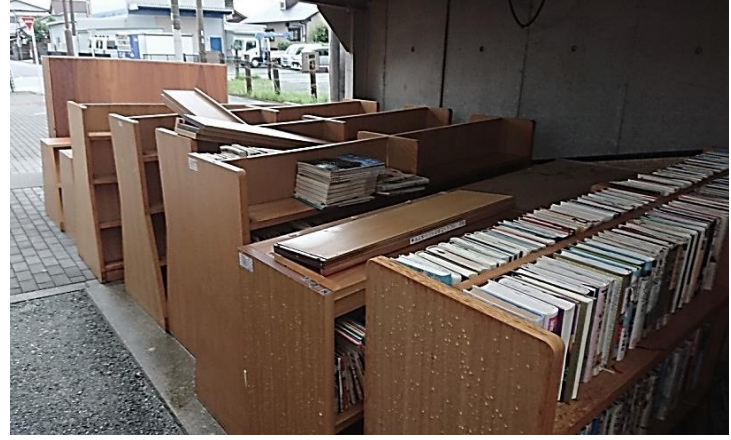
水に浸かった本と本棚です。(廃棄処分です) 本と本棚にはカビが発生し、水を吸収した本棚は変形し板が剥がれていました。
