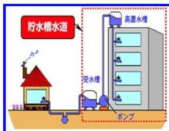
図-3.6.2 貯水槽水道の概念図
