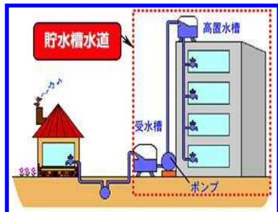
図-3.6.2 貯水槽水道の概念図
