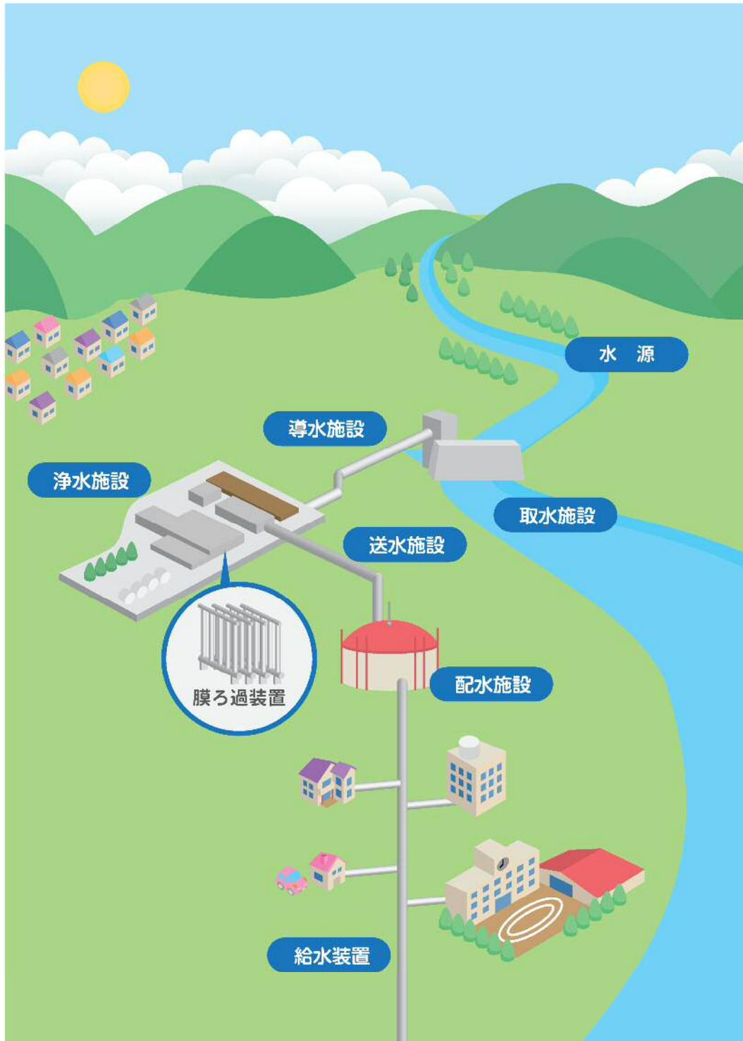
図-3.2.1 水道水ができるまでの全体工程図
